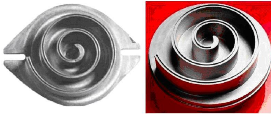
Fig.10.10. Spirala fixa (stator) respectiv spirala mobilă (rotor)
